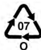
El número SPI 07 se emplea para "Otro". Esto refiere a otros plásticos como PMP, PFA, PTFE etc. No obstante, VITLAB no utiliza el "0", sino que identifica la materia prima específica con la abreviatura según DIN 7728, para así facilitar la identificación del plástico al usuario.
