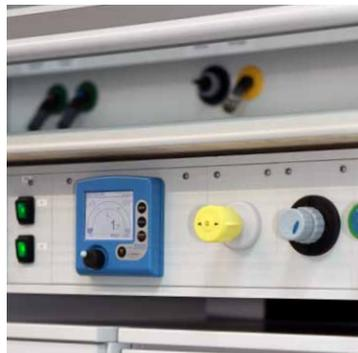
Línea VACUU·LAN® con controlador CVC 3000 E para control de vacío de la línea. Ahorra espacio la integración en los muebles de laboratorio.
