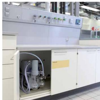
Laboratorio con ahorro de espacio en el suministro del vacío. Control de vacío conveniente de la bomba con CVC 3000 E integrado.
