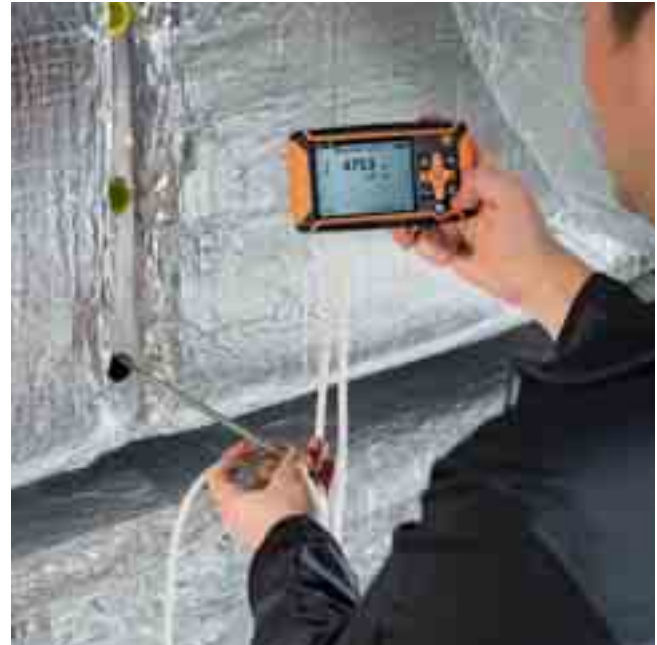
Instrumento de medición extraíble para poder realizar mediciones con tubo de Pitot en el canal (tubo de Pitot se puede adquirir por separado)
