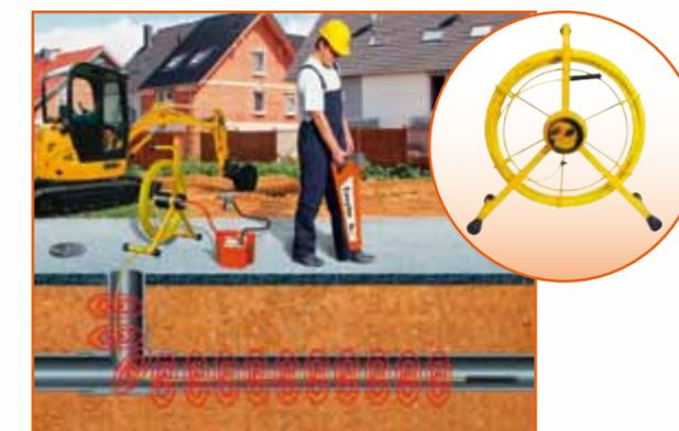
Empleando un cable de localización de fibra de vidrio (GOK) será capaz de localizar segura y exactamente canalizaciones o conductos para cables. Dependiendo de la conexión al emisor Easyloc TX se puede, bien localizar el trayecto completo, o bien sólo la punta del cable. El GOK se encuentra disponible en gran número de longitudes.
