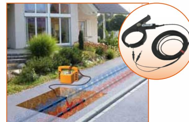
Con la pinza emisora Easyclamp especialmente adaptada al Easyloc, puede inducir señales en cables sin retirarlos de la red. La pinza emisora se coloca en torno al cable en el que se desea inducir la señal y se conecta al emisor Easyloc Tx.
