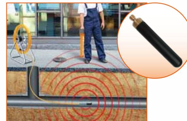
La sonda transmisora MLS 55-3 es un mini emisor que funciona con batería y tiene un alcance de 5 m. Se emplea (atornillado a un vástago flexible de empuje) para localizar conductos para cables u obstrucciones.
