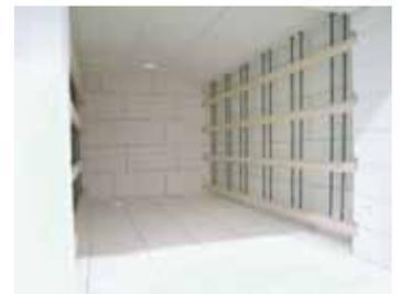
Rejilla de protección delante de los elementos calefactores para protegerlos de daños mecánicos
