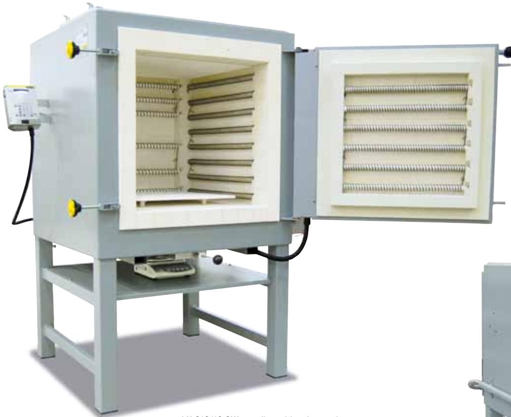
LH 216/12 SW con dispositivo de pesaje para medir la pérdida por calcinación
