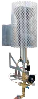
**Antorcha de gas de escape** para la postcombustión de los gases de escape que se forman. La antorcha se calienta por gas y se acciona con gas propano. Se recomienda para procesos en los que no se puede emplear un catalizador.
