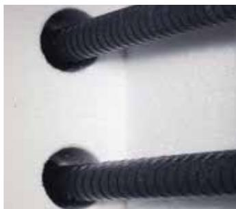
Cámara del horno en fibra de alta calidad y varillas calefactoras de SiC a ambos lados
