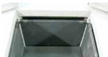
Cámara del horno S 73/HS encajada con placas SiC
