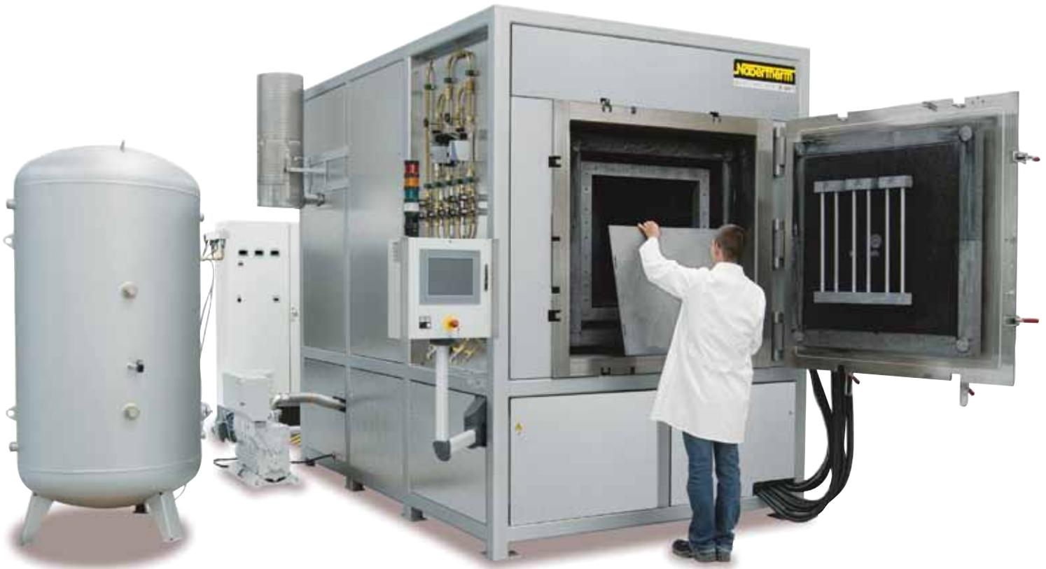
VHT 500/22-GR H<sub>2</sub> con paquete de ampliación para el funcionamiento con hidrógeno y recipiente de proceso de CFC
