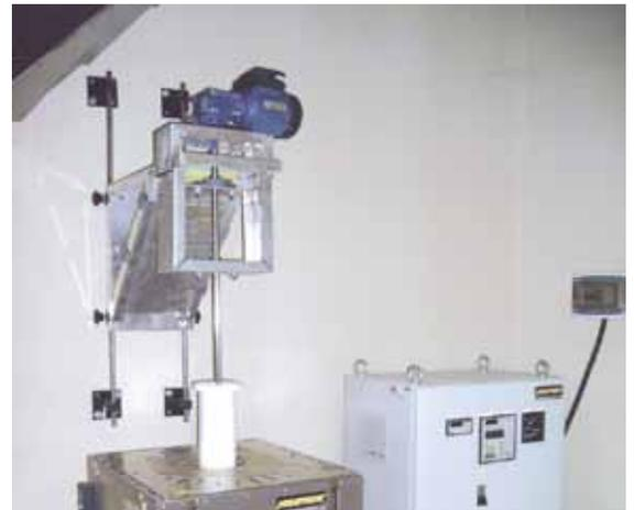
RHTV 120/300/15 integrado en un dispositivo de prueba de tiro
