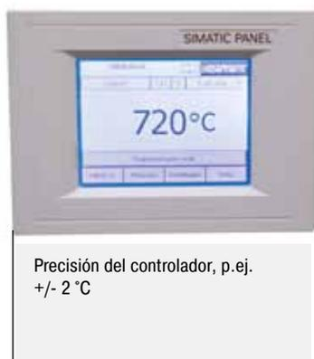
La precisión del sistema resulta de la adición de las tolerancias del controlador, del elemento térmico y del espacio útil
