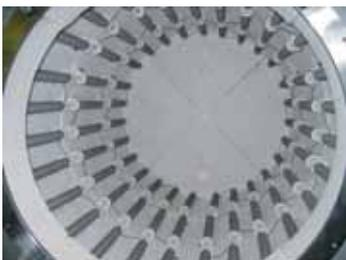
Calentamiento por todo el contorno exterior de la retorta, en los modelos NRA ../09 y NR ../11
