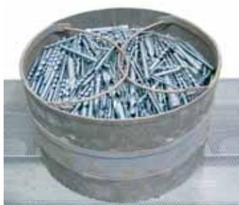
Pavonado mediante vapor de agua en un horno de la serie NRA
