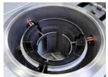
Retorta cilíndrica con calefacción de wolframio
