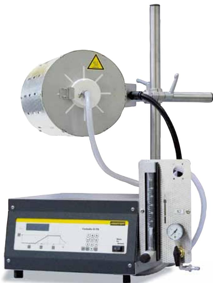
RT 50-250/11 con sistema de suministro de gas para nitrógeno
