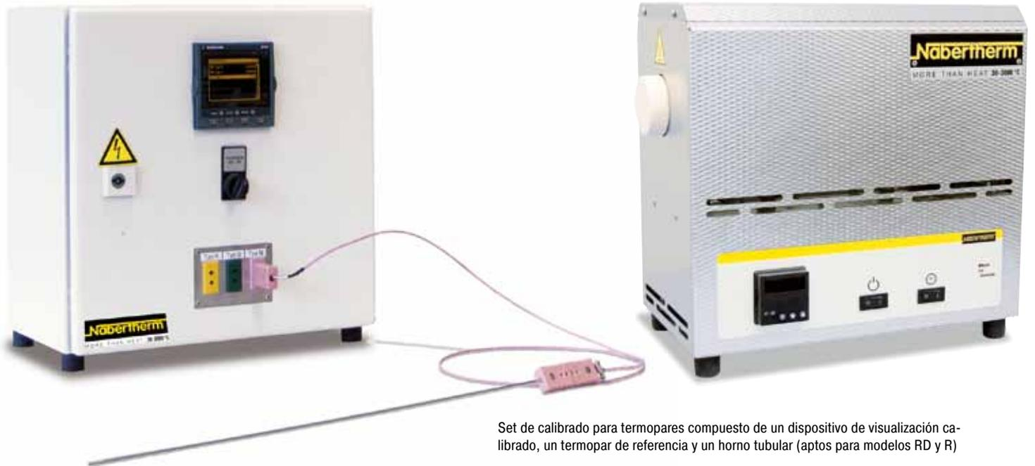
Set de calibrado para termopares compuesto de un dispositivo de visualización calibrado, un termopar de referencia y un horno tubular (aptos para modelos RD y R)
