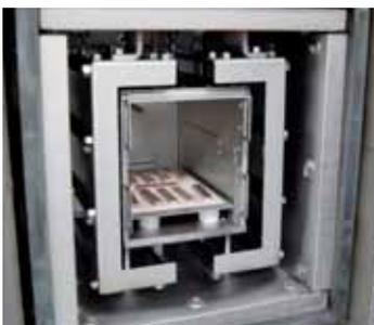
Tratamiento térmico de varillas de cobre bajo hidrógeno en VHT 08/16 MO
