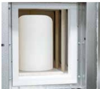
Cubierta suplementaria de proceso con sistema de suministro de gas a través de la base del horno, protege la cámara del horno de impurezas y evita una interacción química entre la carga y las resistencias
