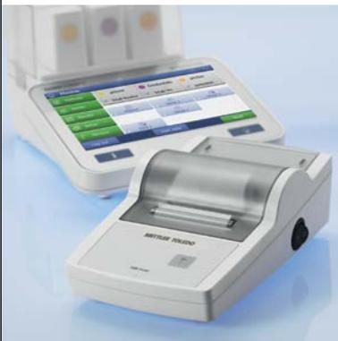
El instrumento incorpora un paquete de funciones de compatibilidad con GLP, como protección con PIN, formato de impresión GLP con toda la información de GLP relevante y monitorización de los límites de medida. Los resultados de la memoria y su impresión aparecen marcados si están fuera de los límites predefinidos.
