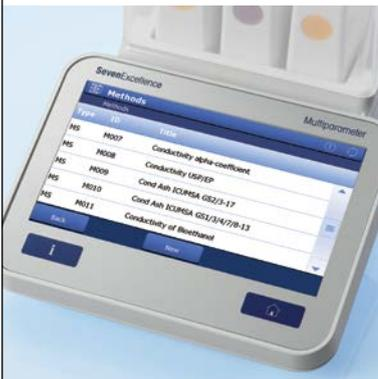
Además de ser más seguros, más reproducibles debido a la configuración idéntica y más cómodos, los métodos también le permiten ejecutar aplicaciones especiales para conductividad. Entre estas se incluye la medida de USP/EP del agua pura con supervisión de los límites y medidas de las cenizas de conductividad de acuerdo con dos normativas de la ICUMSA.
