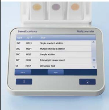
Se incluyen los métodos especiales para las técnicas de medida de concentraciones de iones incrementales más frecuentes, como los métodos de adición/sustracción de diversos estándares y adición/sustracción de muestras. Así dispone de una herramienta flexible y moderna para las medidas de concentraciones de iones profesionales.
