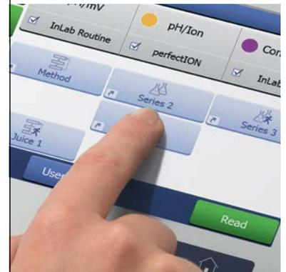
Puede iniciar un método solo con hacer clic en un acceso rápido: una secuencia de pasos de análisis con parámetros predefinidos fijos. El uso de los métodos garantiza que su análisis específico se realiza siempre con la misma configuración.
