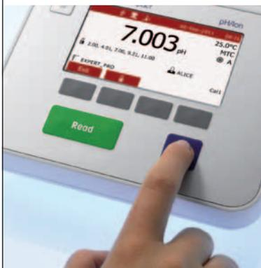
Los instrumentos ofrecen asistencia para la calibración en varios niveles, que incluye grupos de tampones predefinidos y definidos por el usuario, un recordatorio de calibración con bloqueo opcional de sensor y un icono de sensor de pH, que muestra la calidad de la última calibración de electrodo.
