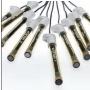
SevenCompact™ S220 permite usar nuestra serie PerfectIon™ de electrodos selectivos de iones combinados y nuestro conjunto de semicélulas. Para mediciones con sensores de semicelda, existe una conexión para electrodos de referencia.
