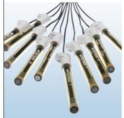
Con SevenExcellence es posible usar nuestra serie perfectION™ de electrodos combinados selectivos de iones y nuestra gama de semiceldas. Para las medidas con sensores de semiceldas existe una entrada para conectar un electrodo de referencia.
