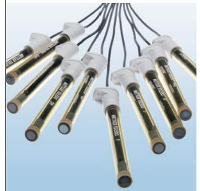
Con SevenExcellence es posible usar nuestra serie perfectION™ de electrodos combinados de iones selectivos y nuestro conjunto de semiceldas. Para las medidas con sensores de semiceldas existe una entrada para conectar un electrodo de referencia.
