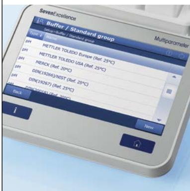
Elija uno de los ocho grupos de tampones de calibración predefinidos o cree su propio grupo fácilmente. Con la función Pick-and-Mix™ puede combinar con comodidad tampones de pH de diferentes grupos. Tras la calibración, el icono del sensor le muestra de un vistazo la calidad de la calibración.
