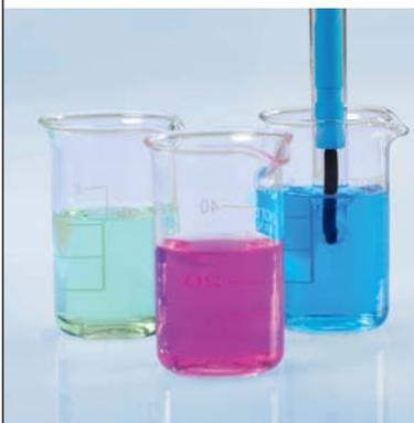
El uso de los métodos es una forma segura y eficaz de calibrar un sensor de pH. Una vez que se ha creado un método, se usa la misma configuración en cada calibración. Los límites de offset y pendiente pueden monitorizarse para prevenir que se guarde una calibración deficiente.
