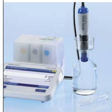
El contenido de DBO de las aguas residuales puede revisarse de la manera más sencilla. Con el adaptador especial DBO, el sensor se adapta para medir en todas las botellas DBO comunes. Según EPA (Environ. Protection Agency, USA) se debe reconocer que gracias a la tecnología RDO ya no se debe agitar la muestra. Con el kit S900-BOD está listo para empezar a trabajar.
