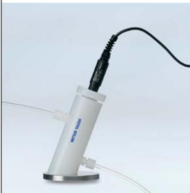
Las mediciones de baja conductividad requieren especial atención. Al medir agua pura o ultrapura, hay varias fuentes potenciales de error, como el dióxido de carbono del aire y la imprecisión de la temperatura. Nuestra célula de conductividad digital InLab® Trace, con gran exactitud de temperatura y célula de flujo opcional, ofrece la solución perfecta.
