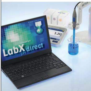
El software para PC LabX direct pH permite exportar de modo sencillo y eficaz los resultados durante el análisis. Solo es preciso activar una vez la configuración de transferencia de este software en el instrumento para que habilite automáticamente el funcionamiento instantáneo.
