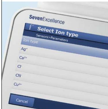
Los doce tipos de iones usados con más frecuencia se preprograman en el instrumento para que la configuración sea lo más cómoda posible. Para otros puede introducir la carga iónica y la masa molar con el objeto de garantizar que todos los cálculos y conversiones se realizan de forma automática.
