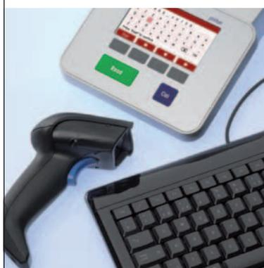
Cuando hay muchas muestras, existe una función para introducir diferentes ID de muestras rápidamente. Al leer un código de barras o escribir en el teclado, la pantalla de introducción de muestras se abre y puede verse la nueva entrada.
