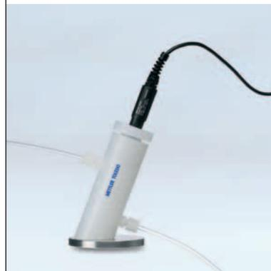
Las mediciones de baja conductividad requieren especial atención. Al medir agua pura o ultrapura, hay varias fuentes potenciales de error, como el dióxido de carbono del aire y la imprecisión de la temperatura. Nuestra celda de conductividad InLab® Trace, con gran precisión de temperatura y célula de flujo opcional, ofrece la solución perfecta.
