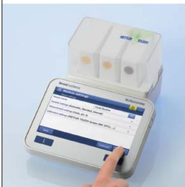
El instrumento ofrece soporte para la calibración en numerosos niveles, incorporando métodos con una secuencia de calibración fija, evaluación automática de los resultados de calibración con rechazo opcional y monitorización del tiempo y el intervalo de calibración del sensor. Es posible una calibración automática con el cambiador de muestras Rondolino.
