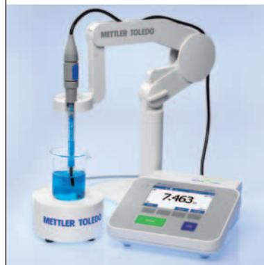
El agitador magnético opcional de METTLER TOLEDO está controlado y alimentado por el instrumento. La agitación puede realizarse antes o durante la medición y la velocidad de agitación puede ajustarse en la configuración del menú para reflejar la viscosidad de la muestra o el tamaño del recipiente de muestras.
