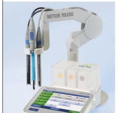
uPlace™: el brazo del electrodo puede manejarse con una sola mano y se mueve perfectamente hacia arriba y abajo para colocar el electrodo en la posición ideal. De este modo, se pueden realizar medidas más rápidas y reducir el riesgo de que el recipiente de muestras vuelque o dañe el sensor.
