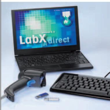
SevenCompact™ cuenta con una interfaz USB A y USB B para conectar un lector de código de barras o teclado, un módulo USB o un PC con el software LabX direct. El reconocimiento del dispositivo USB se indica visualmente cuando aparece el icono correspondiente en la pantalla.
