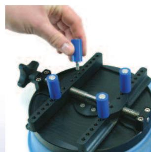
Los pivotes de sujeción son ajustables fácilmente en función de la dimensión y forma de la muestra.
