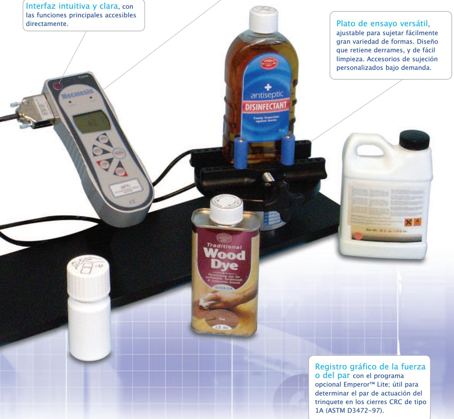
**Registro gráfico de la fuerza o del par** con el programa opcional Emperor™ Lite; útil para determinar el par de actuación del trinquete en los cierres CRC de tipo 1A (ASTM D3472-97).
