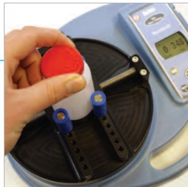
Plato de ensayo versátil, ajustable para sujetar gran variedad de formas. Diseño que retiene derrames, y de fácil limpieza.
