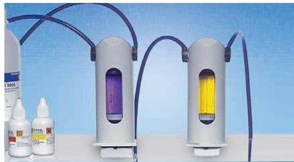
Soporte para dos buretas, dos electrodos y dos agitadores.
