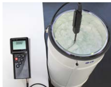
P795 Kalibrierung am Eispunkt P795 Ice point calibration
