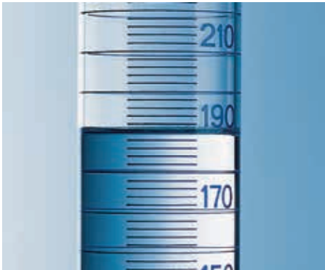
BLAUBRAND®. Marca anular en los puntos principales. Lectura a la altura del punto más bajo del menisco.
