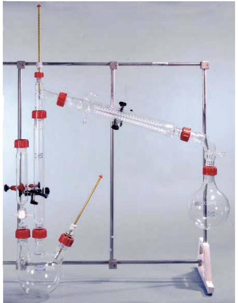
Rectificación a vacío con adición
