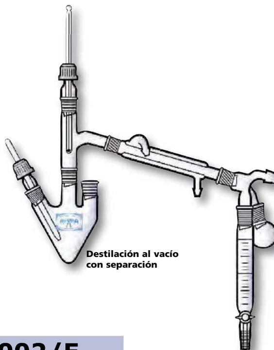
**Destilación al vacío con separación**
