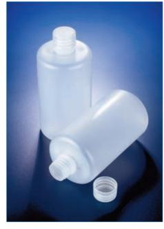
Al autoclavar frascos asegurarse de que las tapas esten completamente aflojadas o incluso quitadas para evitar accidentes por
