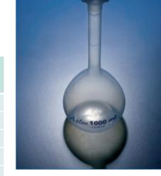
La exposición a temperaturas de hasta 60° puede afectar a la precisión y eliminar las impresiones.
